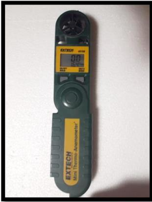
**Figura N° 5.14: Anemómetro utilizado**
