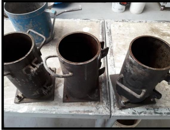
**Figura N° 5.8: Moldes ensayo de compresión**
