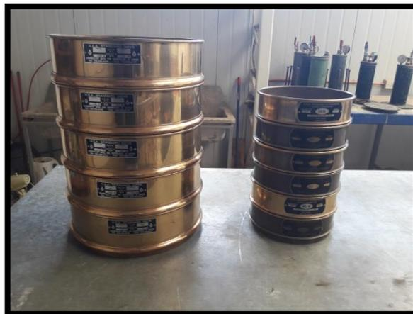
**Figura N° 5.1: Granulometría Grava, Tamiz en mm.**
