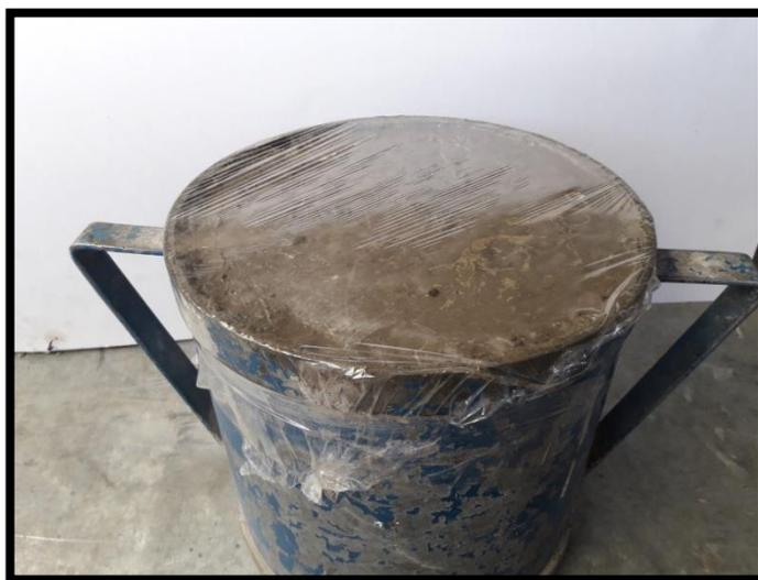
**Figura N° 5.6: Ensayo de exudación**
