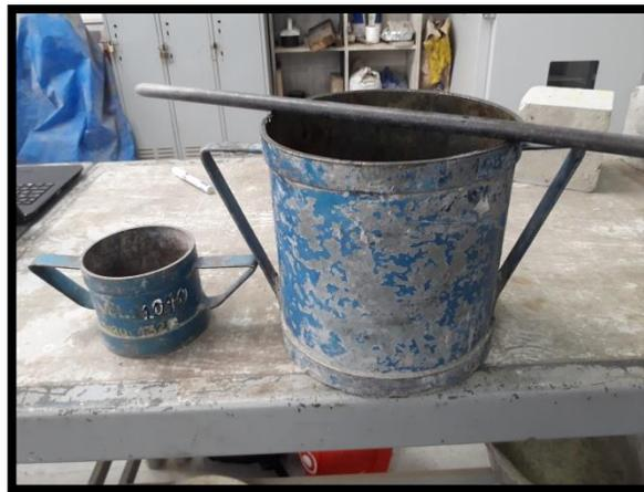
**Figura N° 5.5: Equipo para caracterizar los áridos.**
