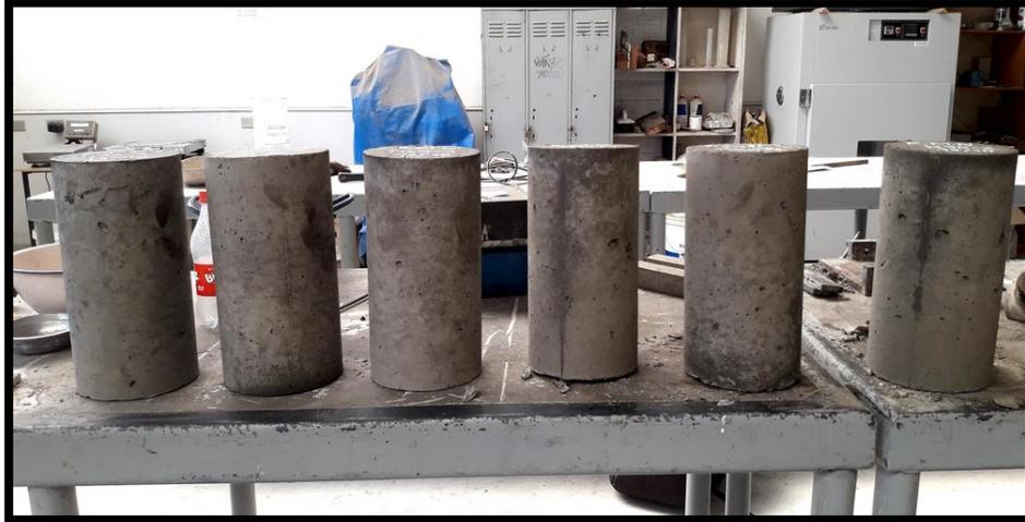
**Figura N° 5.10: Probetas para ensayar compresión**
