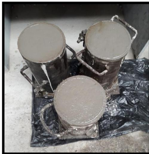
**Figura N° 5.9: Hormigón en molde de ensayo de compresión**
