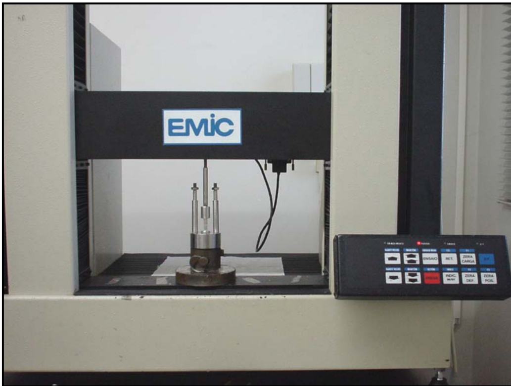
Fig.18 Máquina de ensayo universal Emic DL-500
