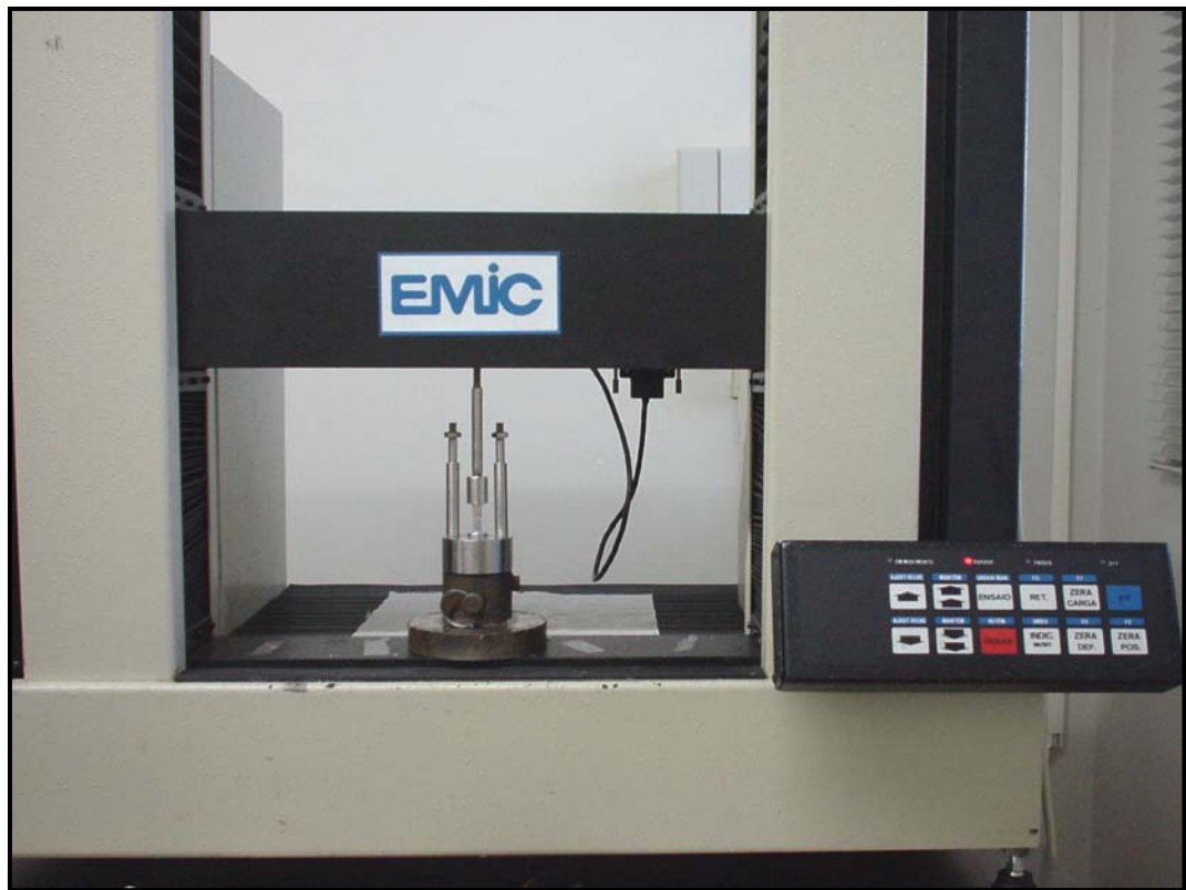
Fig.18 Máquina de ensayo universal Emic DL-500
