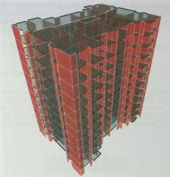
**Figura 3.2. Modelo de análisis en programa Etabs v.9.7.**
