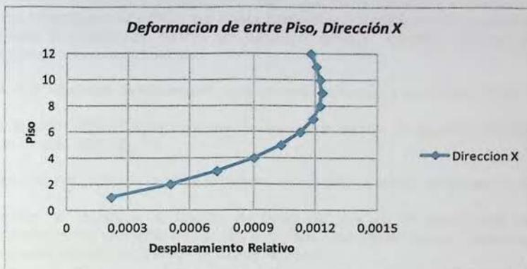
**Figura 3.8. Deformación de entepiso, Dirección X**
