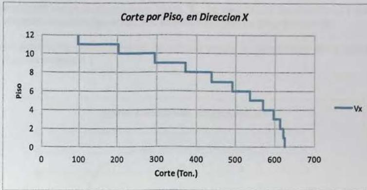
**Figura 3.5. Corte por piso, Dirección X**
