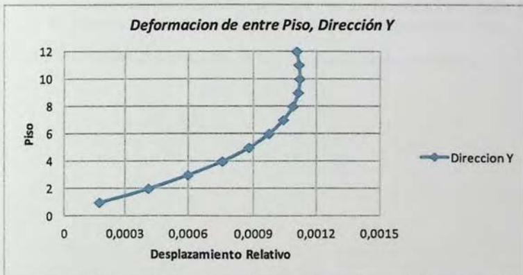
**Figura 3.9. Deformación de entepiso, Dirección Y**
