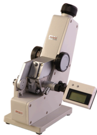
Figura 18. Refractómetro de mesa, utilizado habitualmente para el área química y farmacéutica (46).
