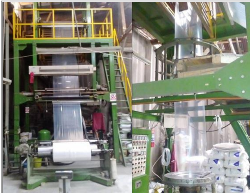
Figura 4.3 - Extrusora mayor (KWEENB, HA- 55). Fuente: Foliplast.
