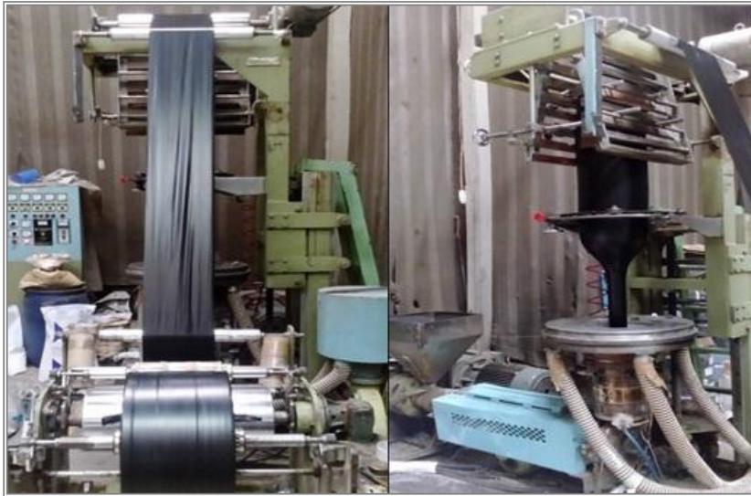
Figura 4.4 - Extrusora menor (GOLDEN MAY, SE/HD 45). Fuente: Foliplast.
