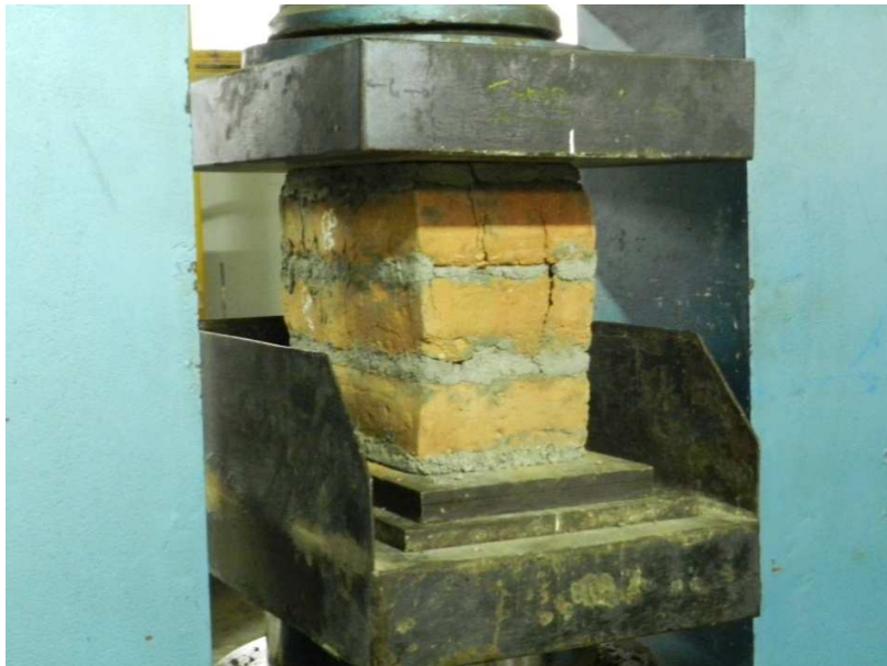
Foto nº 8 destrucción del ladrillo por la compresión
