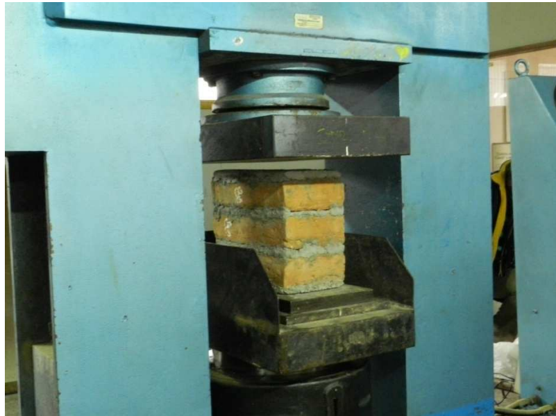
Foto n °7 Prueba de compresión 2
