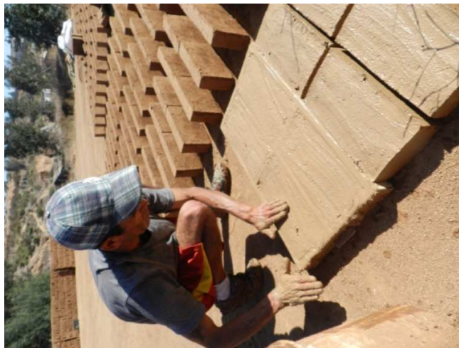
Foto n°2; Formación de Ladrillos ecológicos
