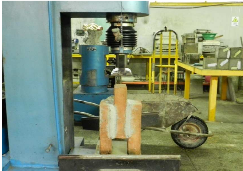
Foto nº 10 Prueba de cizalle 1
