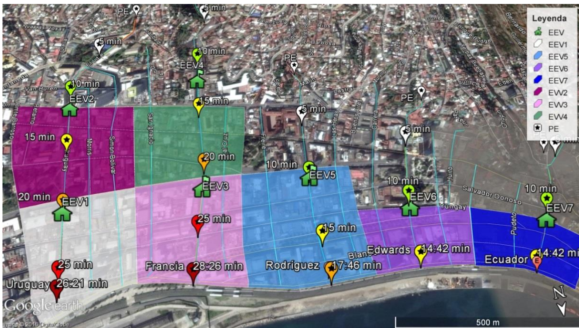
Figura 64 Ubicación teórica estructuras de evacuación vertical (EEV). Elaboración propia.
