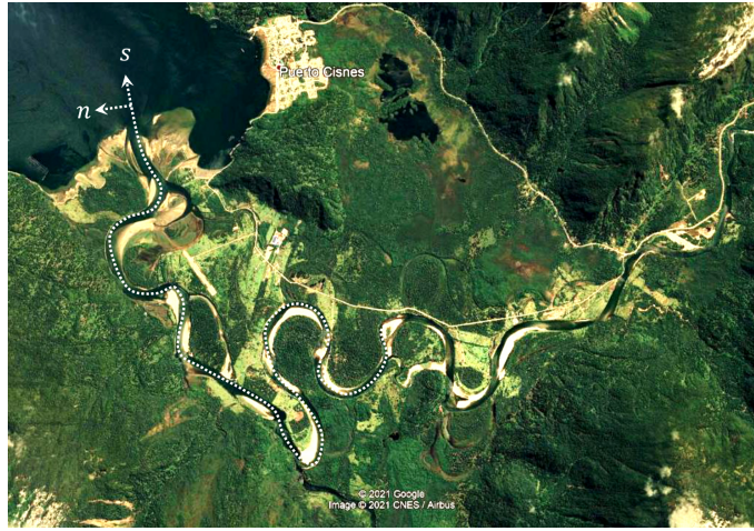
Figura 1.2.11: Desembocadura del Río Cisnes, en la Región de Aysén. Se observan los meandros (curvas pronunciadas) que forma el río en terrenos de poca pendiente y que sugieren el uso, por ejemplo, de un sistema de coordenadas curvilíneas ortogonales (s, n) para caracterizar el flujo.
