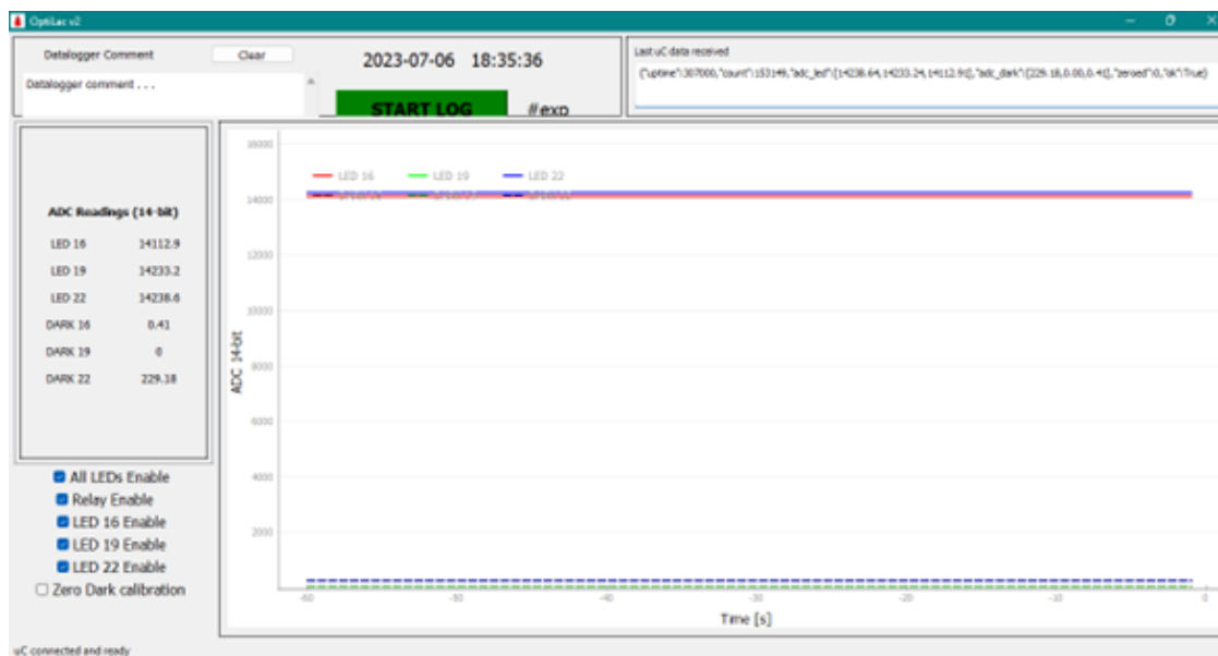
Figura 1: Mediciones de alineación de LEDs y fotodiodos NIR.
