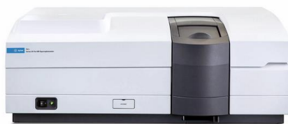
Figura 3.2: Ejemplo de espectrofotómetro comercial UV/VIS/NIR [30].
