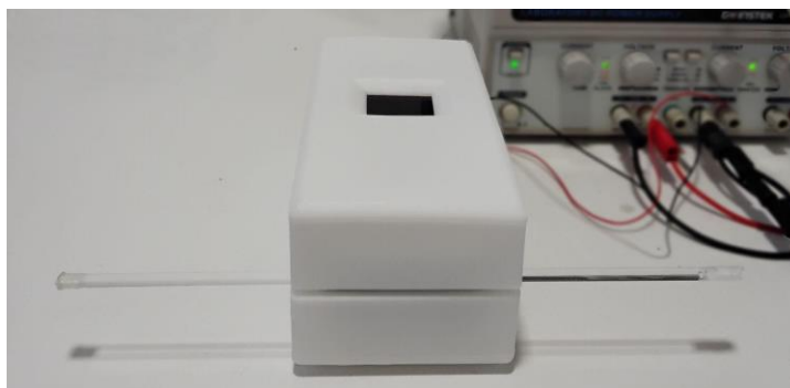
Figura 4.7: Encapsulado del instrumento de medición con el tubo de vidrio rectangular.
