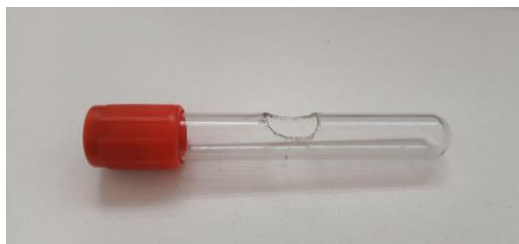
Figura 4.1: Tubo de vidrio en el cual se dispensan las soluciones preparadas para experimentos preliminares.
