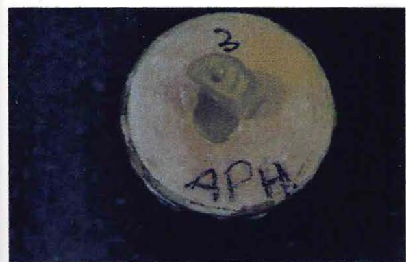
Foto 21 Cuerpos de prueba confeccionados en APH y TPH, fracturados
