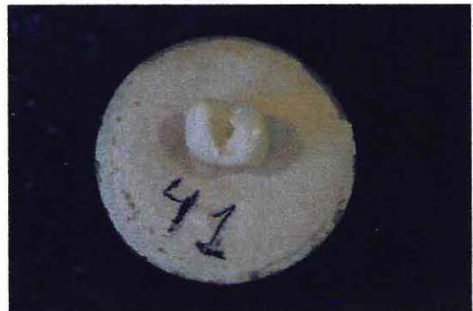
Foto 19 Fallas adhesivas y cohesivas
