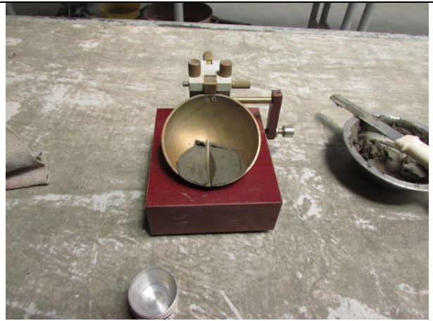
Ensayo de consistencia, acanalador de Casagrande
