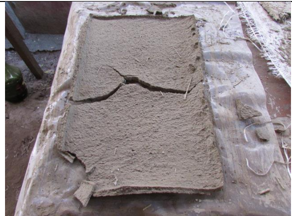
Suelo patrón fisurado por la retracción
