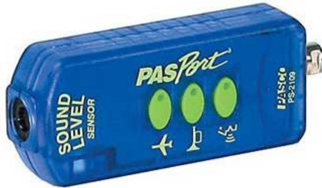
Figura 5.5: Sensor de sonido para Xplorer GLX. Fuente: (Pasco, 2012)
