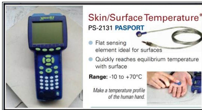
Figura 5.4: Equipo Xplorer GLX y sensores de temperatura superficial
