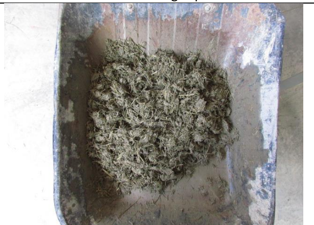
Integración de suelo-ceniza volcánica-paja de trigo
