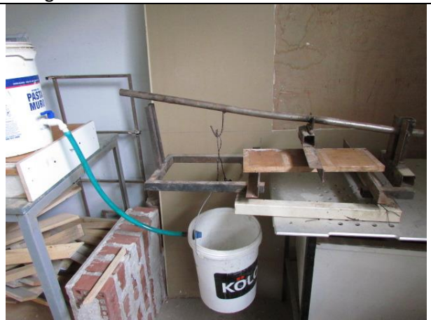
Sistema de medición de cargas por flexión
