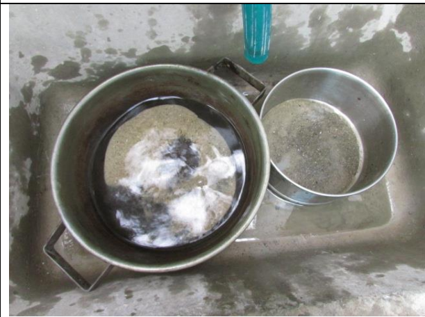
Lavado de suelo para determinar cantidad de fino
