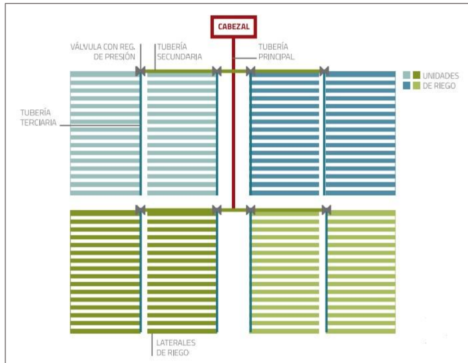
Figura 1.16: Sectores que forman parte de un sistema de riego por goteo. Fuente: Liotta et al. , 2015.
