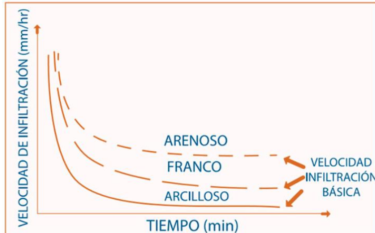
Figura 5.18: Comportamiento de la Velocidad de infiltración según textura. Fuente: (CNR, 2010)
