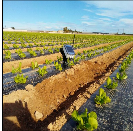
Figura 5.12: Módulo electrónico de un sensor de humedad instalado en un cultivo de hortalizas. Fuente: https://www.redagricola.com/cl/sondas-sensores-humedad-riego-precision-eficiente-sostenible/
