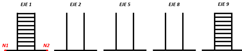
Figura 4.9 – Esquema en elevación de ejes considerados en modelos no lineales de edificios de 10, 15 y 20 pisos.
