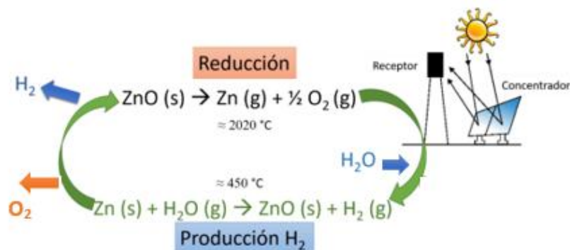
Figura 3.7: Esquema general del ciclo termoquímico de dos etapas basado en ZnO/Zn (adaptado de Satter y Roeb, 2009).
