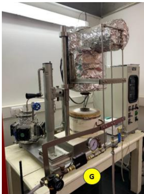
Figura 5.11: Vista controlador de flujo de argón (G)
