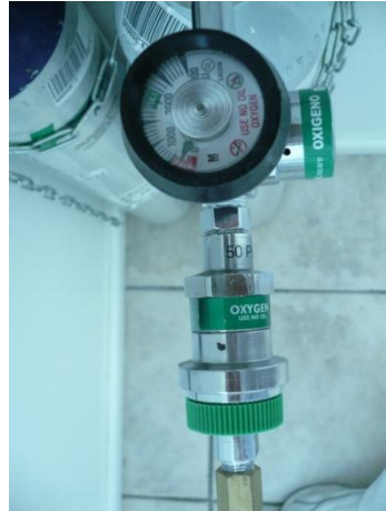
Figura III y IV: sistema de pines de ambos gases
