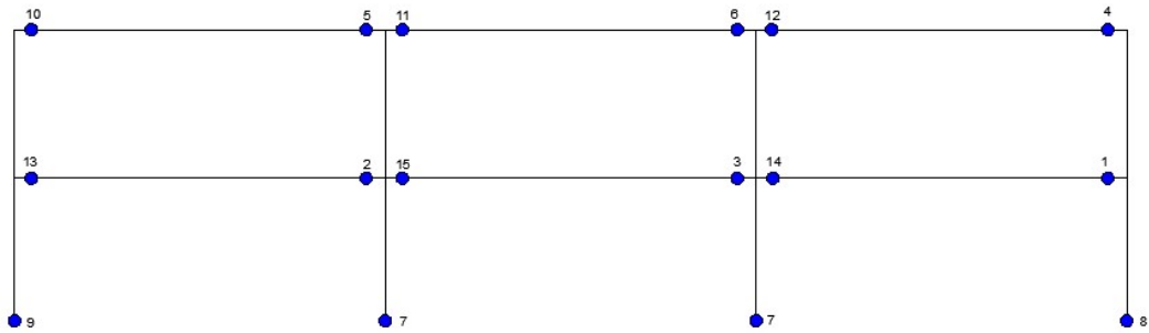
Figura D.8- Mecanismo de colapso de edificio P_2, L_2, Z_3 de OMF
