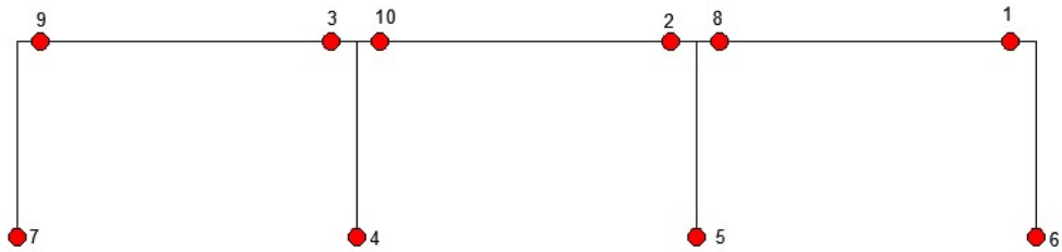
Figura D.13- Mecanismo de colapso de edificio P_1, L_1, Z_2 y P_1, L_1, Z_3 de SMF
