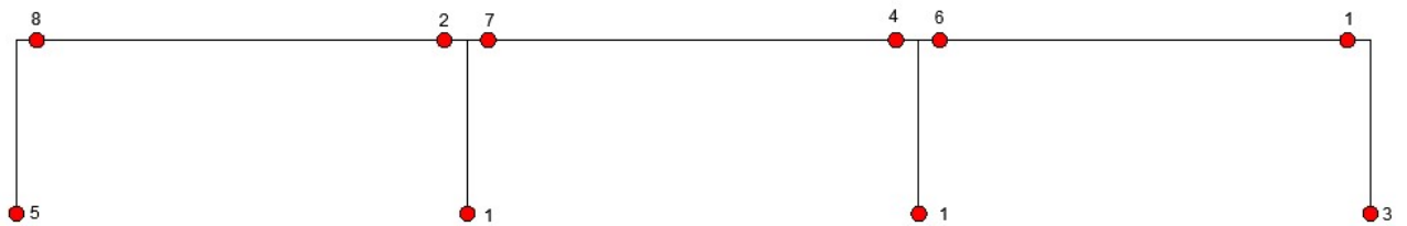
Figura D.14- Mecanismo de colapso de edificio P_1, L_2, Z_2 y P_1, L_2, Z_3 de SMF
