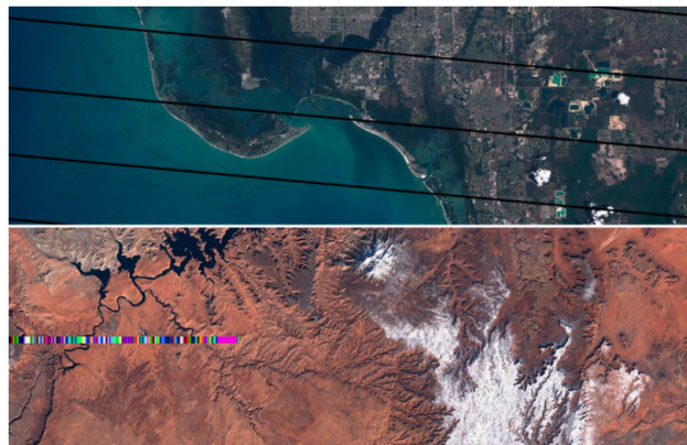
Figura 3.6: Defectos en valores de píxeles.
