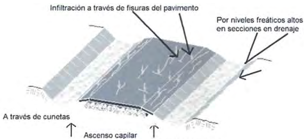
Figura 5.1 - Fuente de humedad en pavimentos Fuente: Guía AASTHO 93'
