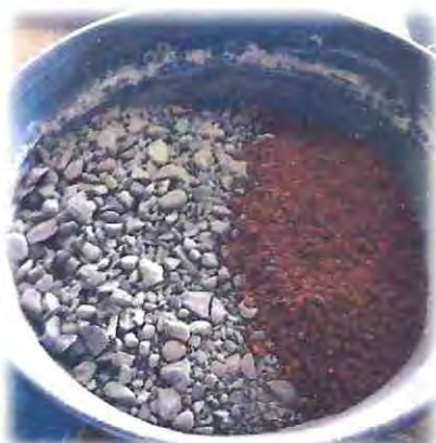
Figura 8.3 - Mezcla base granular con arena-arcillosa
