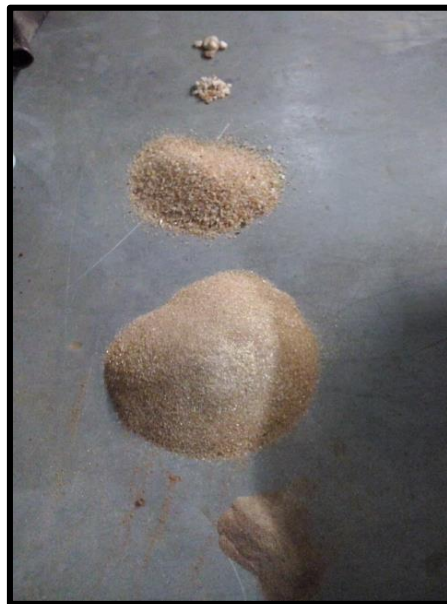
Figura 4.4: Granulometría del suelo
