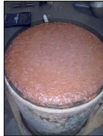
Probeta C.B.R. suelo-cemento (13%) posterior a la inmersión
