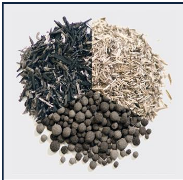
Figura 2.6: Cáscara de arroz y ceniza de cáscara de arroz
