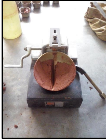
Figura 4.8: Ensayo determinación de límite líquido
