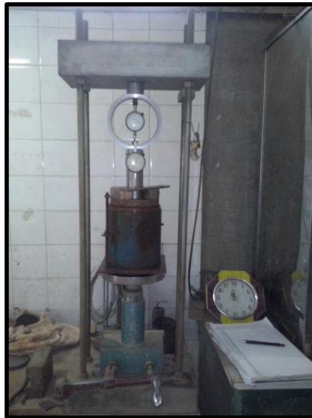
Figura 4.18: Ensaye capacidad de soporte (prensa C.B.R.)
