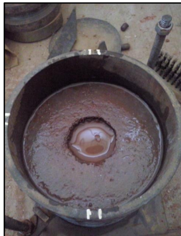
Probeta C.B.R. suelo-cemento-CCA (13%-30%) posterior a penetración
