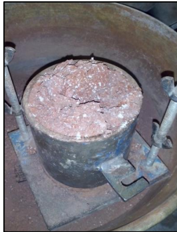
Probeta proctor suelo-cemento (13%) modificado luego de tomar humedades
