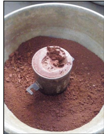
Probeta proctor, retiro de material para determinación de humedades, suelo natural
