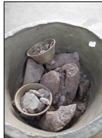
Muestra C.B.R. suelo-cemento-CCA (13%-30%) posterior al secado en horno
