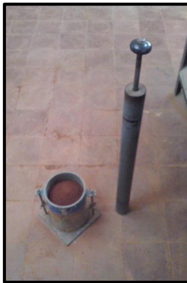
Figura 4.14: Ensayo Proctor Modificado, Método B
