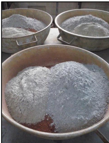
Suelo-cemento-CCA (13%-30%) antes de homogenización
