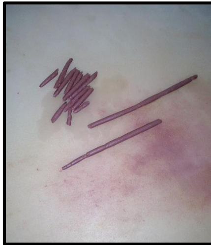
Figura 4.9: Ensayo determinación de límite plástico
