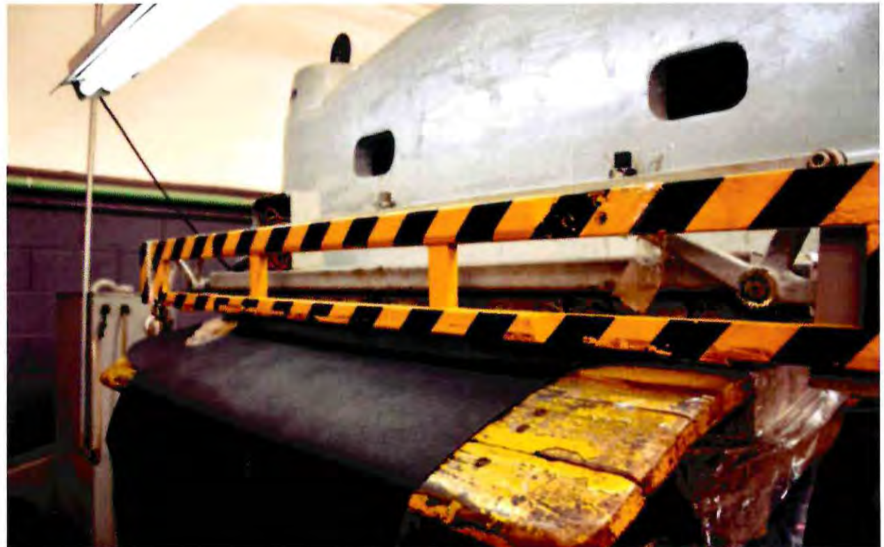
Imagen: Fotografía de planchas que sirven para darles distintos tipos de acabado a las pieles. En este caso el cuero recibió un acabado rondinelo.
