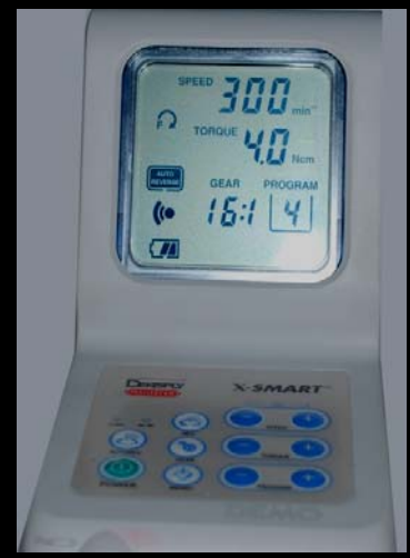
Figura 16.- Motor X-Smart® con programación de velocidad y de torque según lima empleada.
