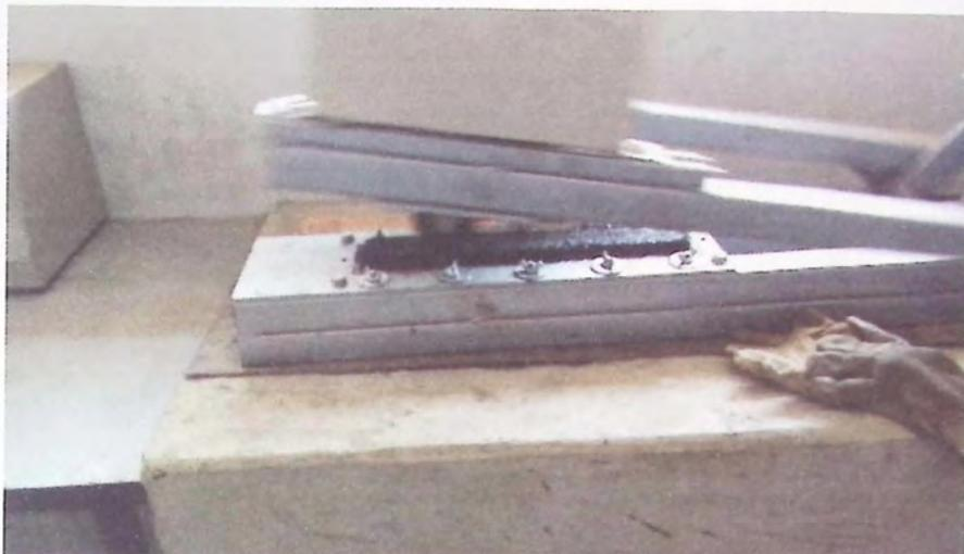
Ilustración 11 - Probeta sometida al ensaye de rueda de carga
