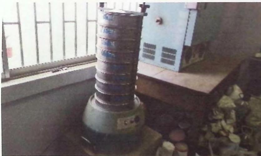
Ilustración 2 - Tamizado del material
