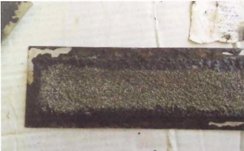
Figura 5.7 - Probeta de lechada asfáltica ensayada a contenido óptimo de emulsión (12 %), árido 80% Ac - 20% An
