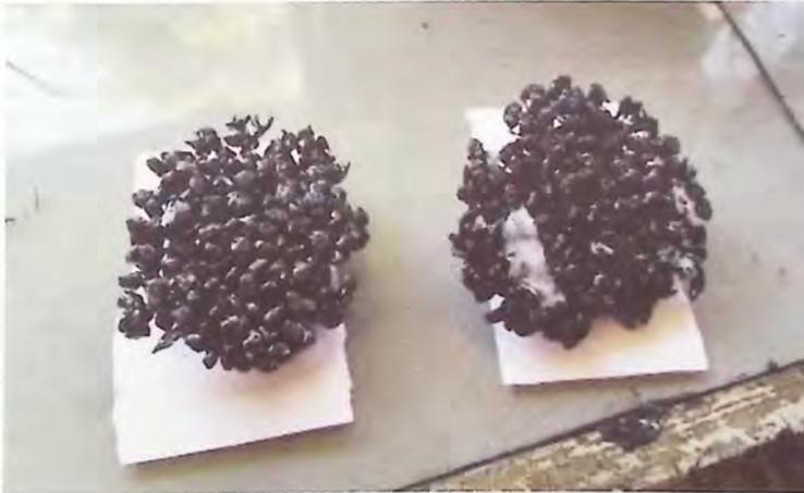
Figura 3.4 - Resultados de ensayo, Adherencia método estático
