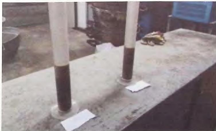
Figura 3.3 - Resultados de ensayo Equivalente de arena
