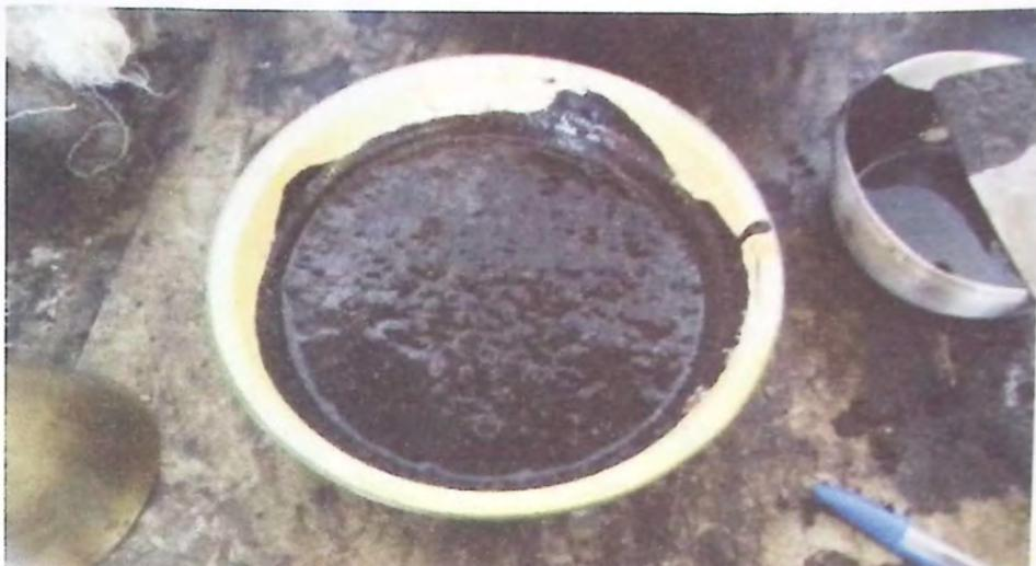
Ilustración 7 - Mezcla de lechada asfáltica con contenido óptimo de emulsión
