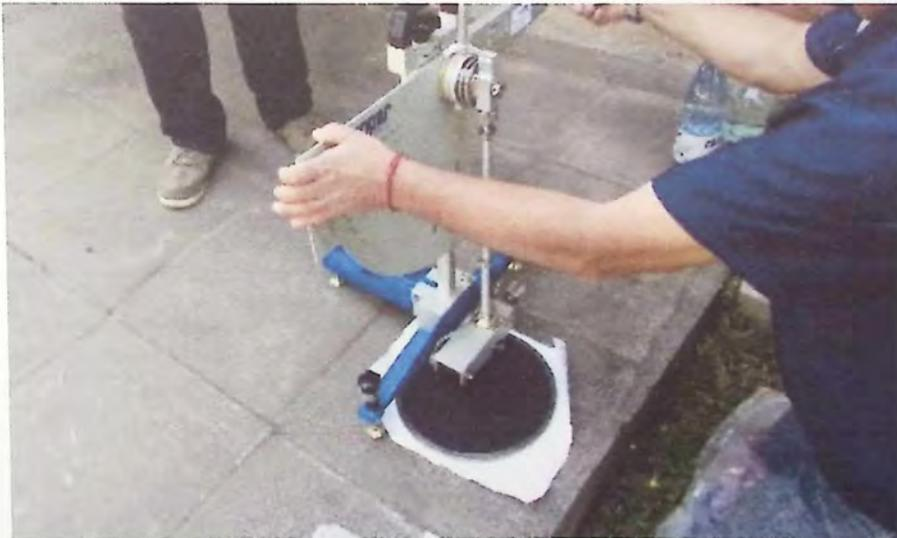
Figura 2.11 - Calibración péndulo británico para determinar la resistencia al deslizamiento en lechadas asfálticas
