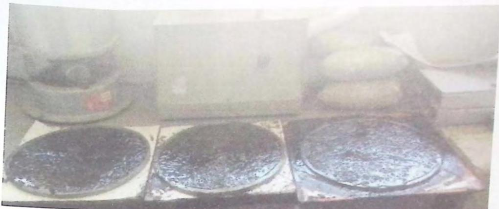
**Ilustración 9 - Moldes para ensayo de abrasión en medio húmedo**
