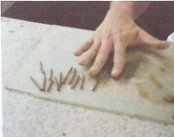
Figura 2.14 - Determinación del límite plástico de un árido (Fuente: Google Images)
