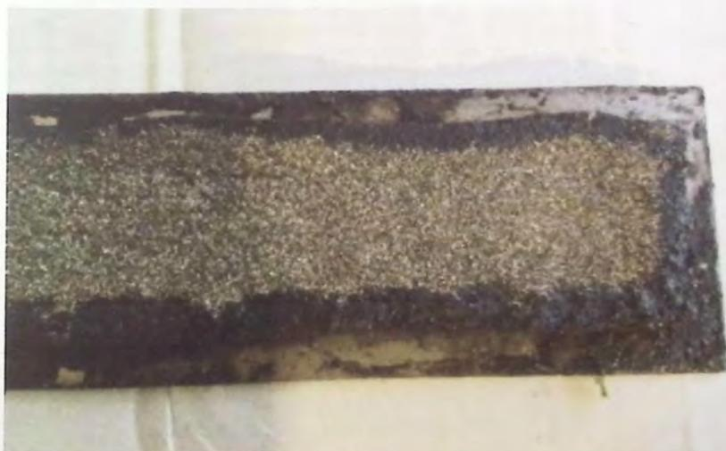
Figura 5.16 - Probeta de lechada asfáltica a un 12% de asfalto, árido 20% Ac - 80% An
