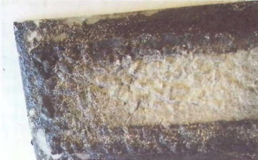
Figura 5.5 - Probeta de lechada asfáltica ensayada a contenido óptimo de emulsión (12 %), árido 100% Ac
