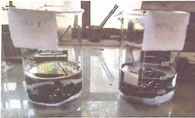
Figura 2.15 - Ensayo de Adherencia método estático
