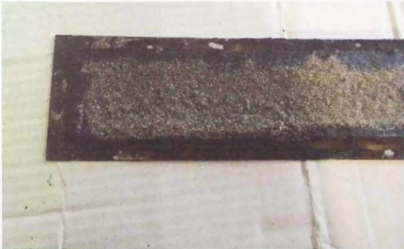
Figura 5.12 - Probeta de lechada asfáltica ensayada a contenido óptimo de emulsión (12 %), árido 60% Ac - 40% An
