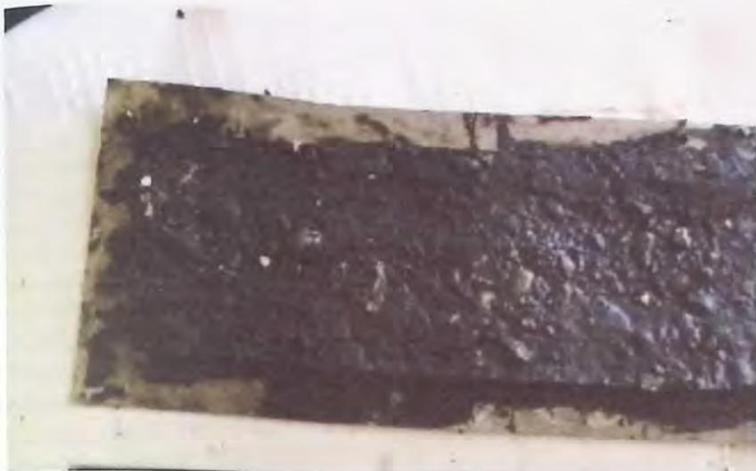
Figura 5.18 - Probeta de lechada asfáltica ensayada a contenido óptimo de emulsión (12 %), árido 100% An
