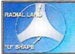
Imagen 21: Sección transversal en U
