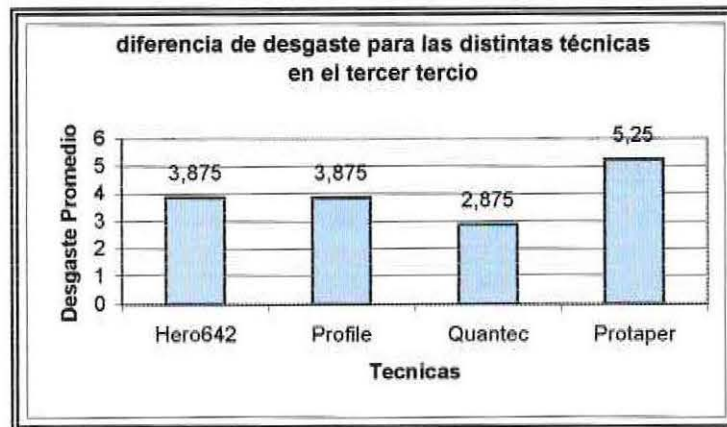
Gráfico N°9: Diferencias promedio (en píxeles) de desgaste entre la pared interna y externa producidas en el en tercio apical para los distintos grupos.
