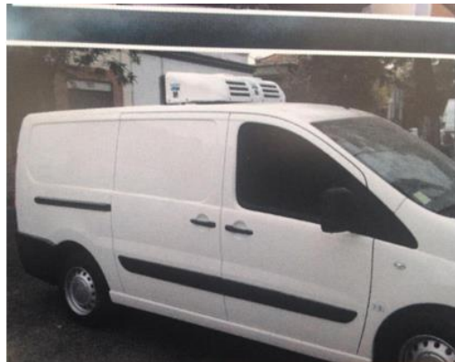
Figura 11: Camioneta de transporte de congelados acondicionada por Airex.
