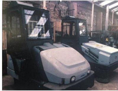
Figura 12: Cabinas acondicionadas de grúas horquillas fabricadas en Airex.
