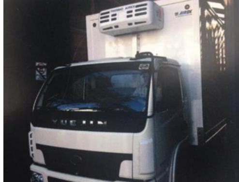
Figura 10: Camión acondicionado para el transporte de elementos térmicos.
