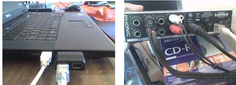
Ilustración 41- Conexiones entre Interfaz y PC
