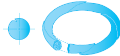
Ilustración 13. Falla en espiral de un o'ring, exhibe una serie de cortes en espiral profundos en la superficie(Carl E. Misch 2014)
