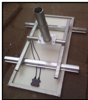
Figura n°31. Montaje porta-panel recomendado (Fuente: Manual Montaje de Poste de BRC Ingeniería, 2021).
