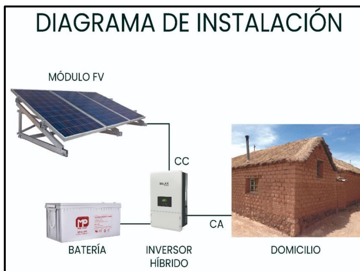
Figura n°35. Sistema Fotovoltaico Domiciliario en Cancosa.
