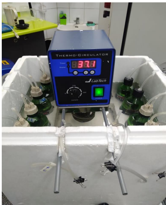
Figura 6.6 Montaje de Biorreactores
