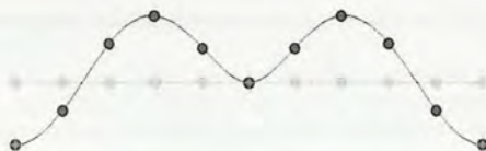
Figura 4.27 – Vista en planta del segundo modo de vibrar para un largo de cañería igual a 100 [m].
