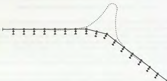
Figura 3.19 – Deformada en zona de quiebre.
