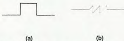
Figura 3.20 – Simbología a) Lazo de expansión (Loop) b) Junta flexible.
