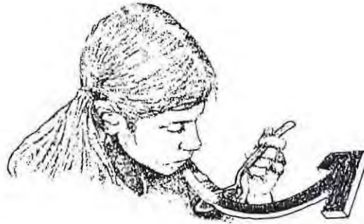
Fig. 10: Enfriamiento por convección forzada.
