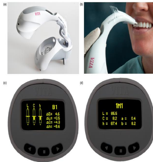
Figura N° 1-19: Vita Easyshade Compact. a). Calibración del instrumento, b). Medición del color. c) Valores de las mediciones de color comparadas con su correspondiente en Vitapan Clásico. d) Correspondencia de los valores con Vitapan 3D- Master. 5
