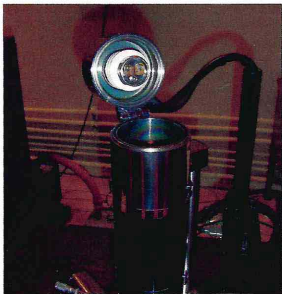
Fotografía N° 8 "Montaje de filamento de Tungsteno emisor de electrones"
