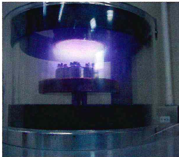
Fotografía N° 7 “Proceso de metalizado”
