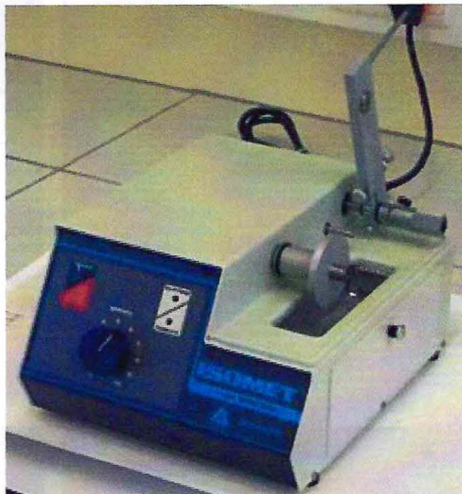
Fotografía N° 2 "Maquina Isomet para corte a baja velocidad"
