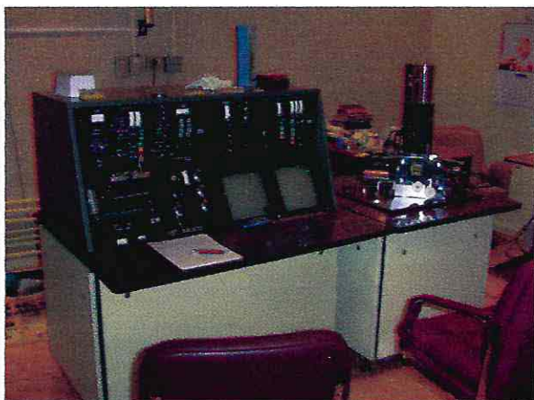
Fotografía N° 10 "Microscopio electrónico de barrido, su unidad óptico electrónica a la derecha y panel de controles a la izquierda"
