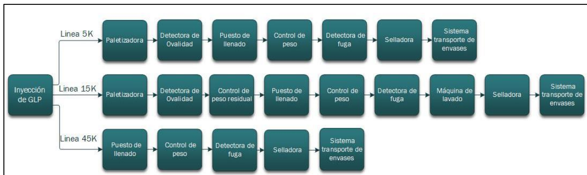
Figura 1.9: Diagrama de bloques, secuencia de máquinas presentes en las líneas de envasado. Observe el detalle del diagrama en el Anexo 1.7.1.
