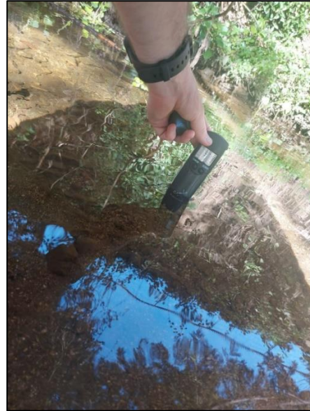
Figura 5.8: Investigador midiendo los humedales urbanos con el Combo Medidor Hanna Modelo HI 98130.
