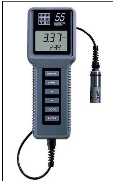
Figura 5.9: Oxímetro YSI Modelo 55. (Fuente: https://www.ysi.com/55 )
