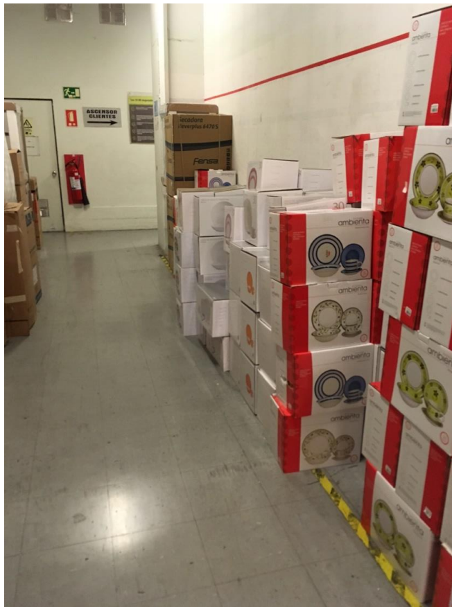
Figura 4.11: Productos en pasillo que sirve también como vía de escape.
