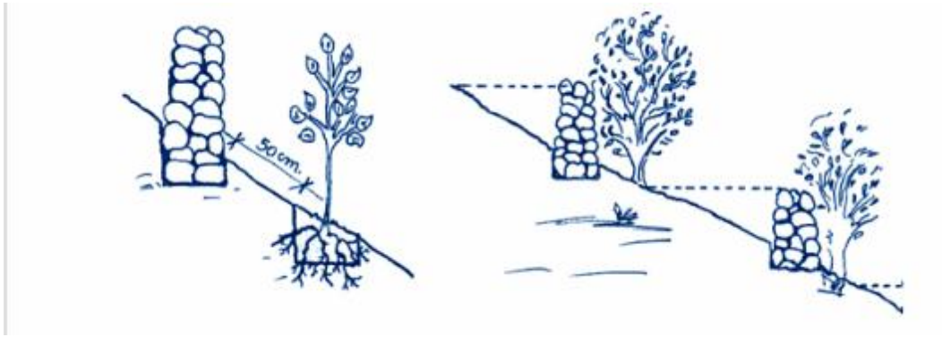
Figura 69: Imagen de elaboración de taqanas en laderas de fuerte pendiente ejemplo tomado del libro Conservación de suelos y fertilidad , producción de plantines forestales de (Hauchani y Carvajal, 2005: 2).
