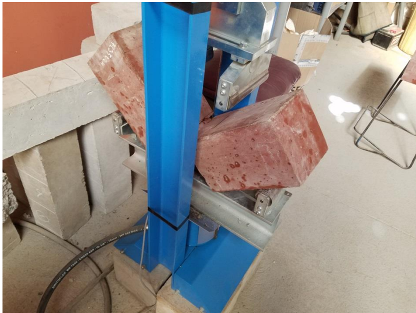
Figura 5.10- Probeta con pigmento rojo en prensa de rotura.
