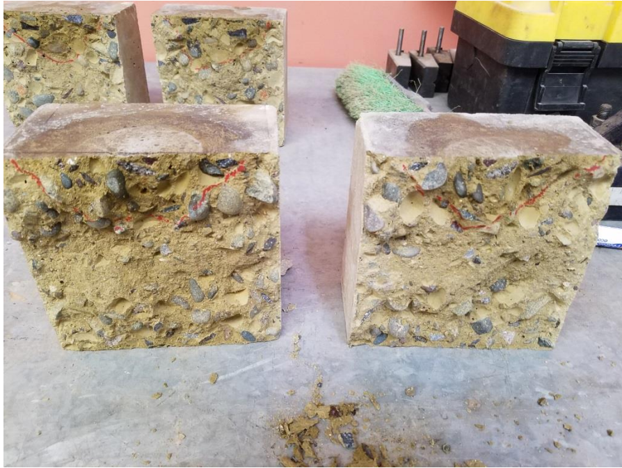
Figura 5.13- Probeta con pigmento amarillo sometido a rotura por hendimiento.
