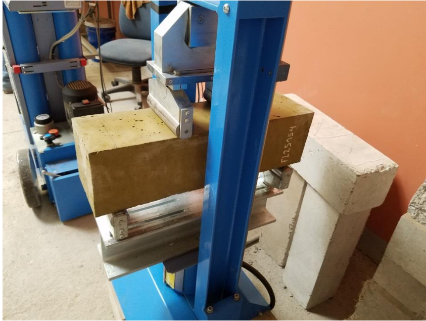
Figura 5.9- Probeta con pigmento amarillo en prensa de rotura.
