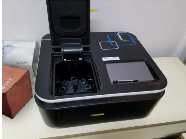
Figura 5.5- espectrofotómetro con probeta con pigmento rojo.
