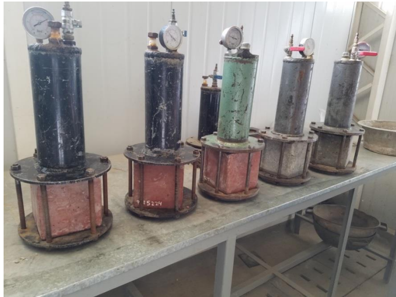
Figura 5.12- Probeta con pigmento rojo y patrón en ensayo de permeabilidad al agua.
