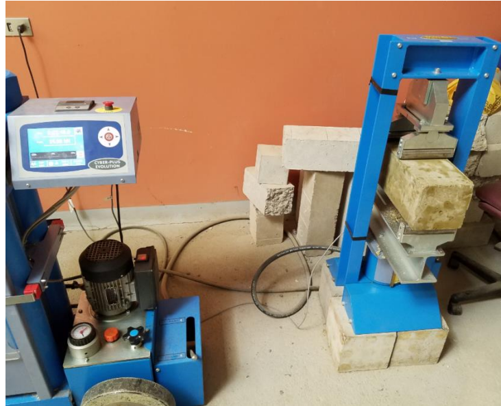
Figura 3.7- Prensa de ensayo
