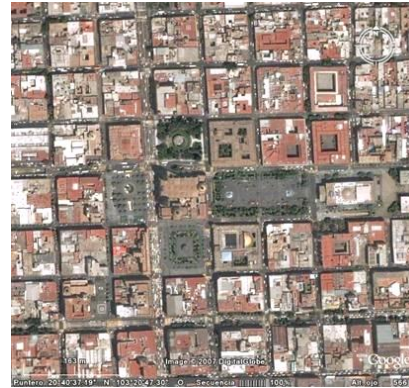
IZQUIERDA: Guadalajara, México. La imagen muestra el centro de ciudad, con la catedral y otros edificios de la época virreinal. Un ejemplo de trama ortogonal.
