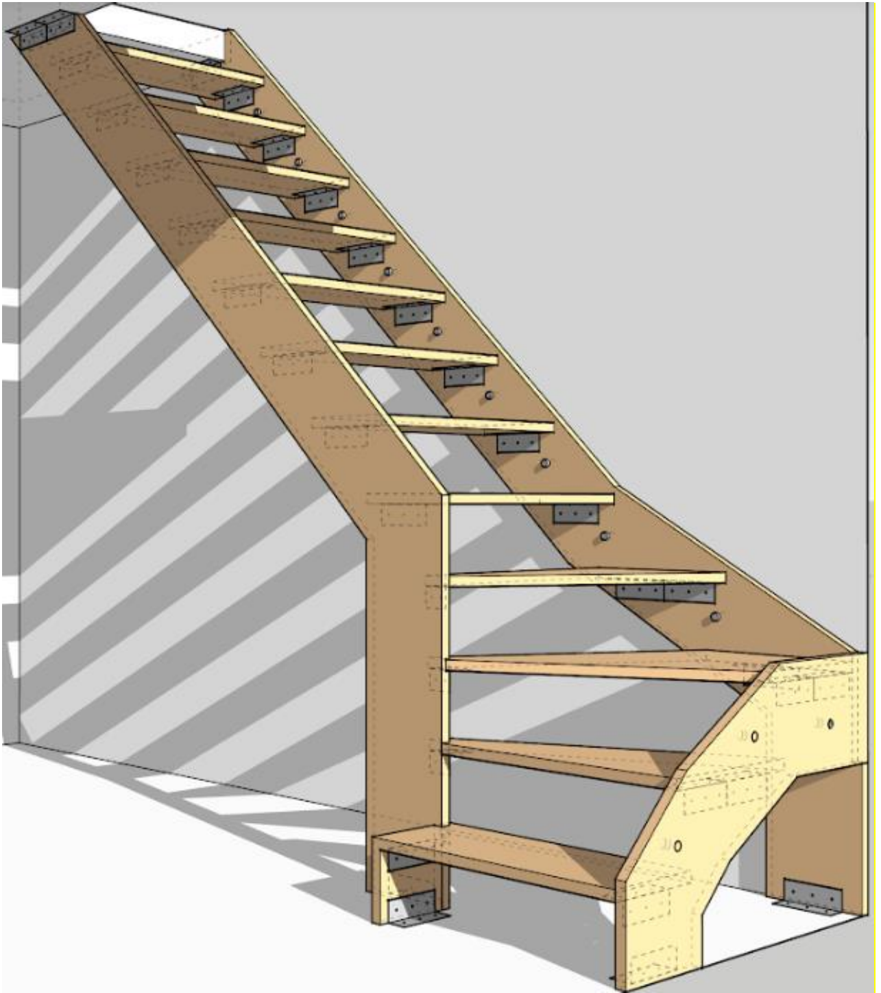
Figura 7. 6 - Modelo 3D de Escalera F2 (FUENTE: PROPIA, 2023)
