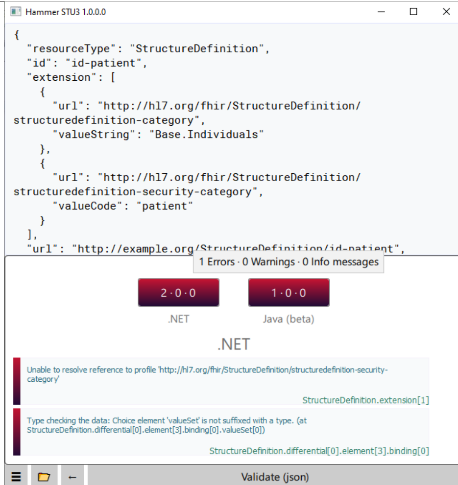
Figura 7: Resultado con errores de un perfilado de paciente en lenguaje JSON, mostrado los errores que este posee con programa Hammer
