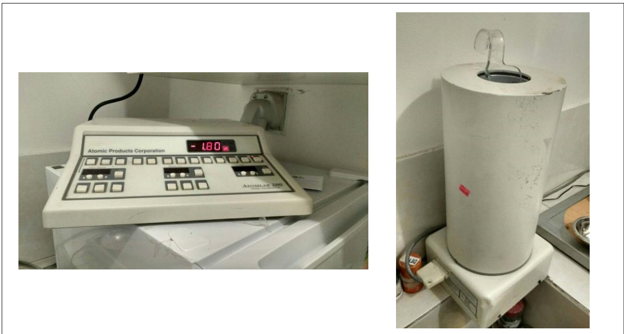
FIGURA 1.4: a. Consola del Activímetro. b. Pozo del Activímetro.
