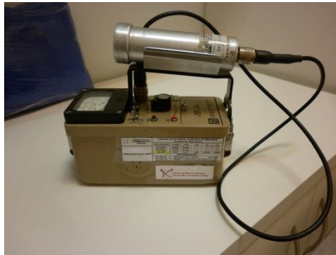
FIGURA 1.7: Detector Geiger Muller
