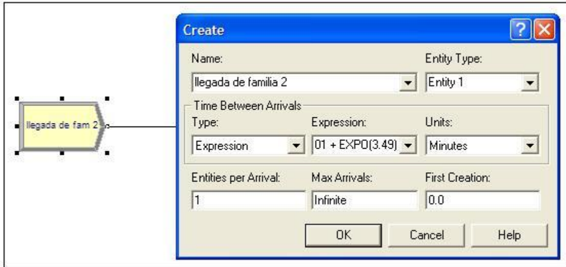
Figura N°15: Parámetro de configuración del bloque “llegada de familia 2” para el escenario N°1.
