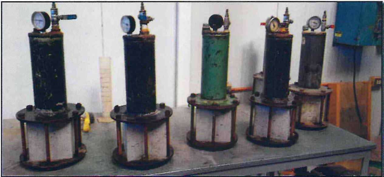
Figura 5.14: Equipo de ensayo para permeabilidad del hormigón.
