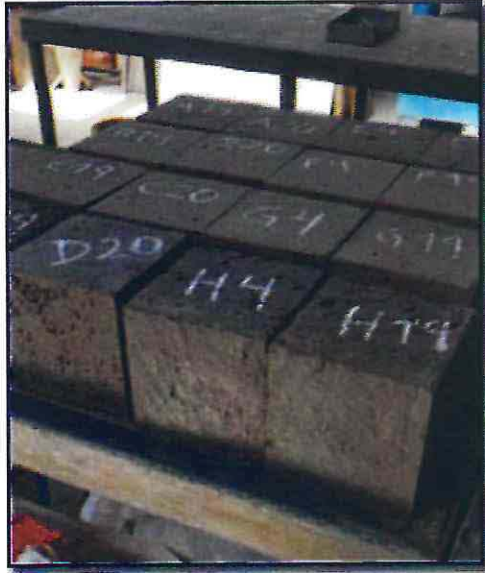
Figura 5.7: Probetas de hormigón para ensayos.
