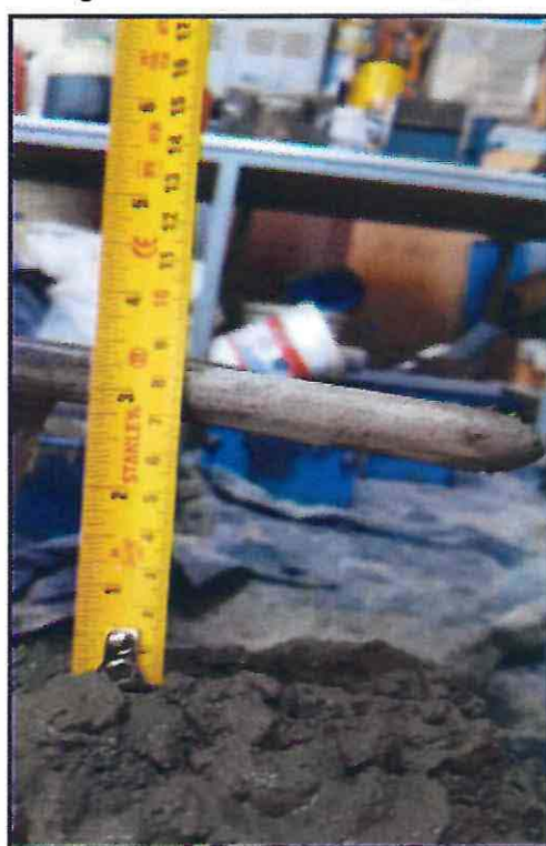
Figura 5.1: Medición de cono de Abrams.
