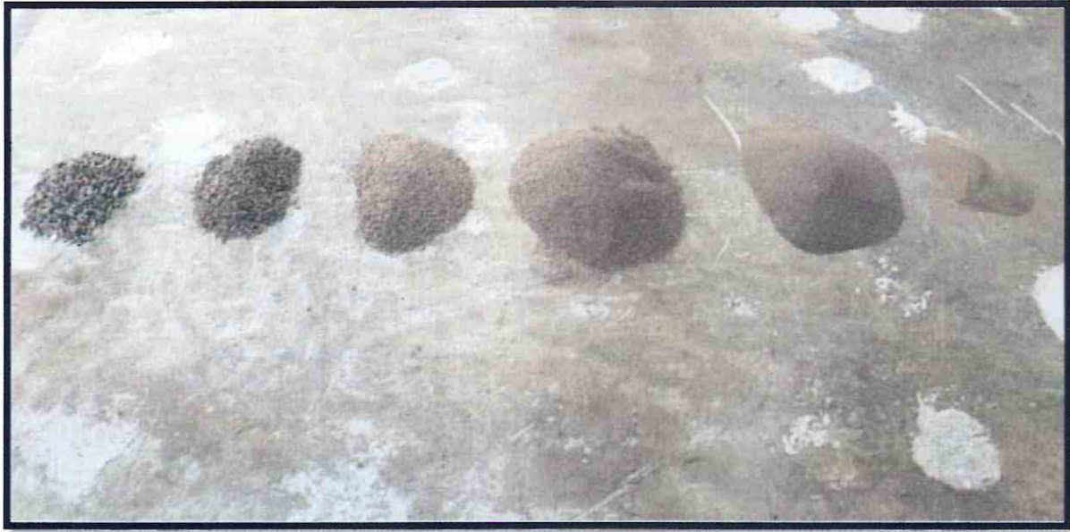
Figura 4.2: Tamizado de la arena.
