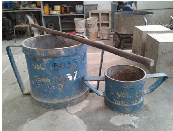
Figura 5.3. Recipientes para calcular Densidad Aparente de Grava y Arena respectivamente.
