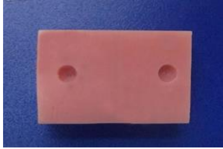
(a) Bloque de acrílico con agujeros para análogos de implante.
