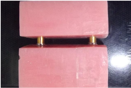
Figura 14. Bloques de prueba montados sobre máquina PASCO AP-8214 durante medición de fuerza de retención.
