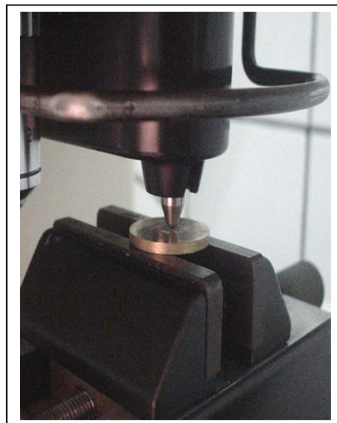
Figura 21: Indentación en los cuerpos de prueba
