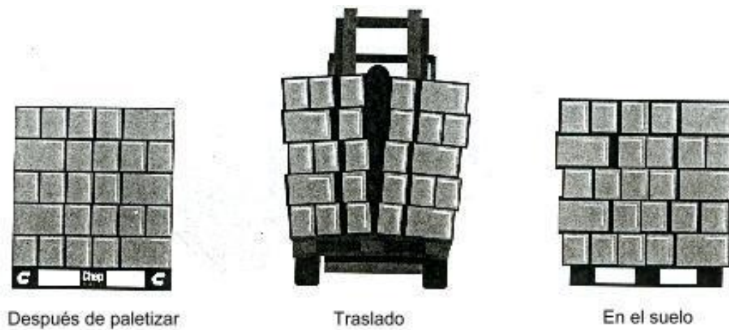
Figura.- Consecuencia de una mala estructuración de cajas
