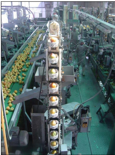
Figura 1-5: Máquina descarozadora ubicada en planta 1 de la empresa.
