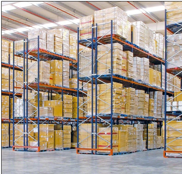
Figura 6-25: Rack o Estanterías de tipo Selectivo.
