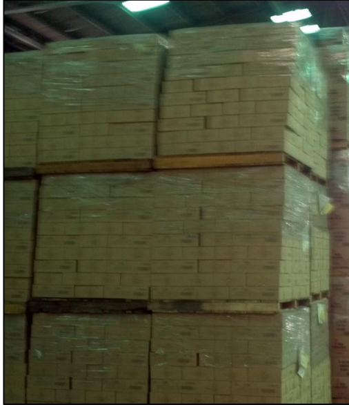
Figura 6-20: Escoramiento y desborde encontrado en la empresa.
