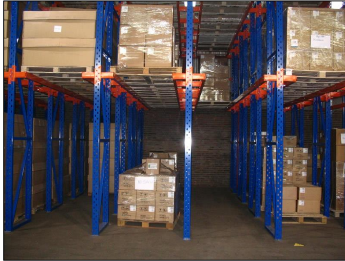
Figura 6-16: Sistema de almacenamiento Drive In
