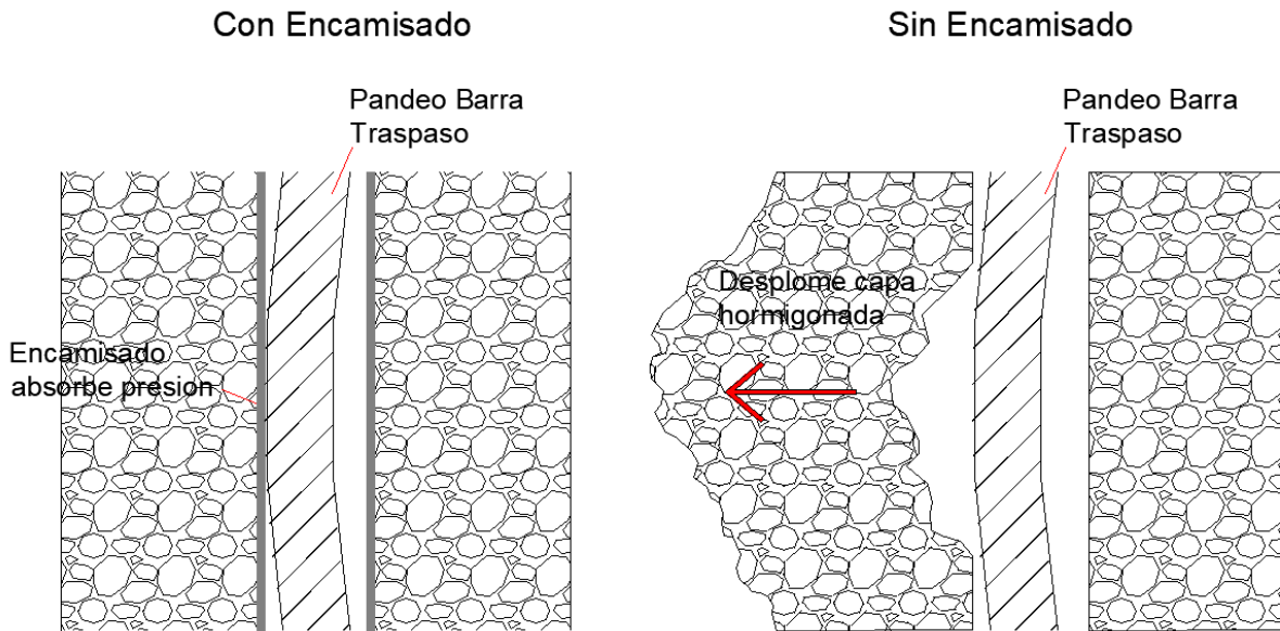
Figura 5.3: Detalle de función de encamisado en sistema de moldaje deslizante
