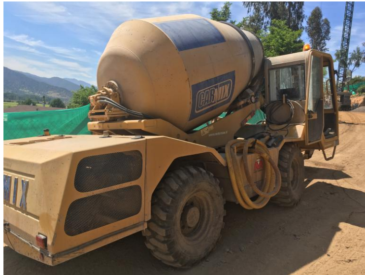
Imagen 5.1: Camión Hormigonero utilizado en el uso de Sistema de Moldaje Deslizante
