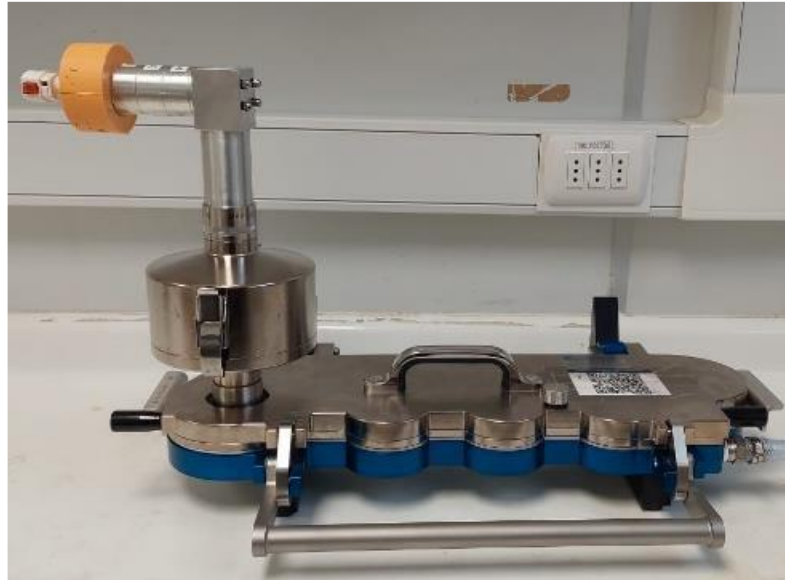
Figura 8: Impactador en cascada Next Generation Impactor (NGI) preparado para el ensayo de impactador en cascada junto al Puerto de Inducción Evaluador de Plumas (PIPE)
