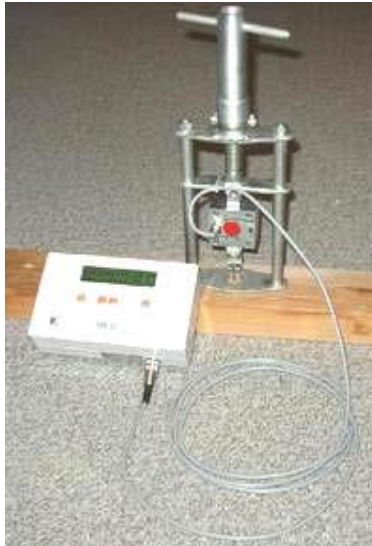
Figura 4. 4 Extractor de tornillos Fuente: Casado et al, 2005.
