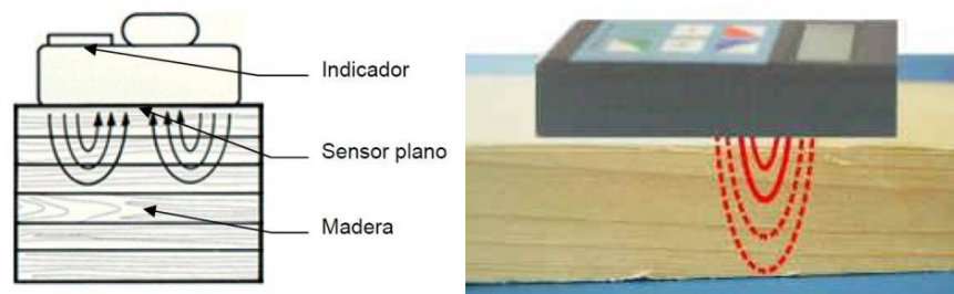
Figura 4. 2 Xilohigrómetro capacitivo Fuente: Superintendencia del Medio Ambiente
