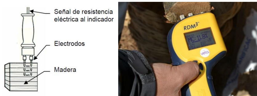
Figura 4. 1 Xilohigrómetro resistivo Fuente: Superintendencia del Medio Ambiente
