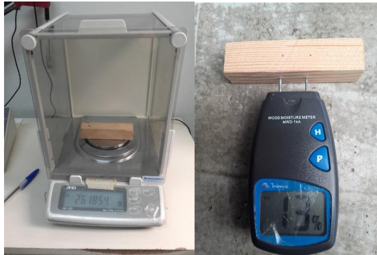
Figura 5. 3 Pesaje y medición de contenido de humedad con xilohigrómetro
